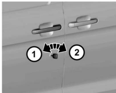
Para bloquear una puerta desde el exterior con una llave, inserte la llave y girela en sentido contrario a las manecillas del reloj (1). Gire la llave en sentido de las manecillas del reloj para desbloquear la puerta (2).
