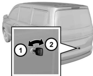
Para abrir la puerta trasera, inserte la llave en la cerradura de la puerta trasera y gírela en sentido de las manecillas del reloj.
