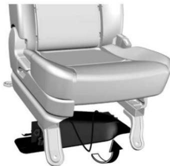
El gato, juego de herramientas y triángulo de advertencia están colocados debajo del asiento del pasajero delantero. Mueva el respaldo del asiento del pasajero delantero y afloje la banda de fijación debajo del frente del asiento para retirar el juego de herramientas.
