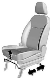
1. Jale hacia arriba la palanca de ajuste en la parte inferior delantera del asiento.
