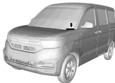
Es la marca de identificación legal del vehículo. El VIN se encuentra en la esquina delantera del tablero de instrumentos en el lado del conductor. Se puede ver desde el exterior a través del parabrisas delantero.
