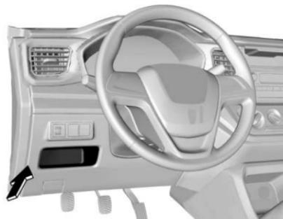
La caja de fusibles interior está en el lado inferior izquierdo del tablero de instrumentos y se localiza debajo de la caja de almacenamiento.
