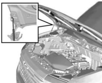
3. Separe la varilla de soporte del cofre de la abrazadera de fijación. Conecte el extremo libre de la varilla de soporte en la ranura.
