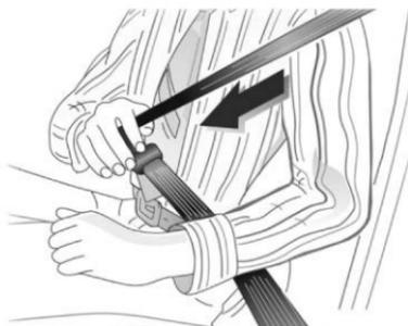
1. Extraiga el cinturón de seguridad del enrollador y ajústelo a través del cuerpo sin torcerlo.
