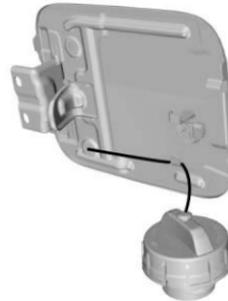
4. Desenrosque el tapón de llenado. Si escucha un sonido de silbido, espere hasta que el sonido se detenga y, a continuación, desenrosque la tapa. El tapón de llenado está conectado a la tapa de llenado con la cadena. Cuelgue la cadena en el colgador de la tapa de llenado para asegurarla.
