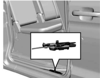
El mecanismo de bloqueo se proporciona junto al riel inferior de la puerta central derecha.
