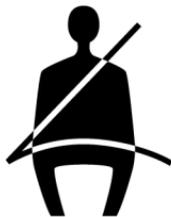
La luz de advertencia del cinturón de seguridad se ilumina si el conductor no se abrocha adecuadamente el cinturón de seguridad después de que se enciende la ignición.
