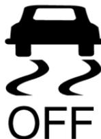
La luz de advertencia se ilumina después que se enciende la ignición y se apaga varios segundos después. Esto indica que la luz de advertencia está funcionando normalmente.
