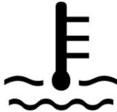
La luz de advertencia de temperatura del refrigerante del motor se ilumina cuando se enciende la ignición, y se apaga varios segundos después. Indica que tanto el sistema como el foco indicador funcionan normalmente.
