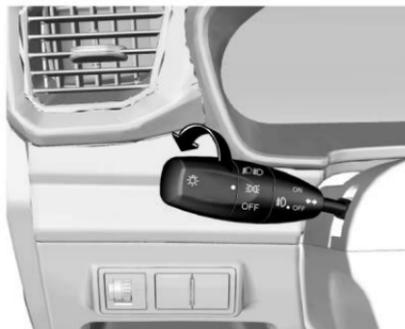
Para encender o apagar el faro, la luz trasera y la luz de estacionamiento, gire el extremo de la palanca de control de la luz.
