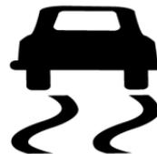
La luz de advertencia se ilumina después que se enciende la ignición y se apaga varios segundos después. Esto indica que la luz de advertencia está funcionando normalmente.
